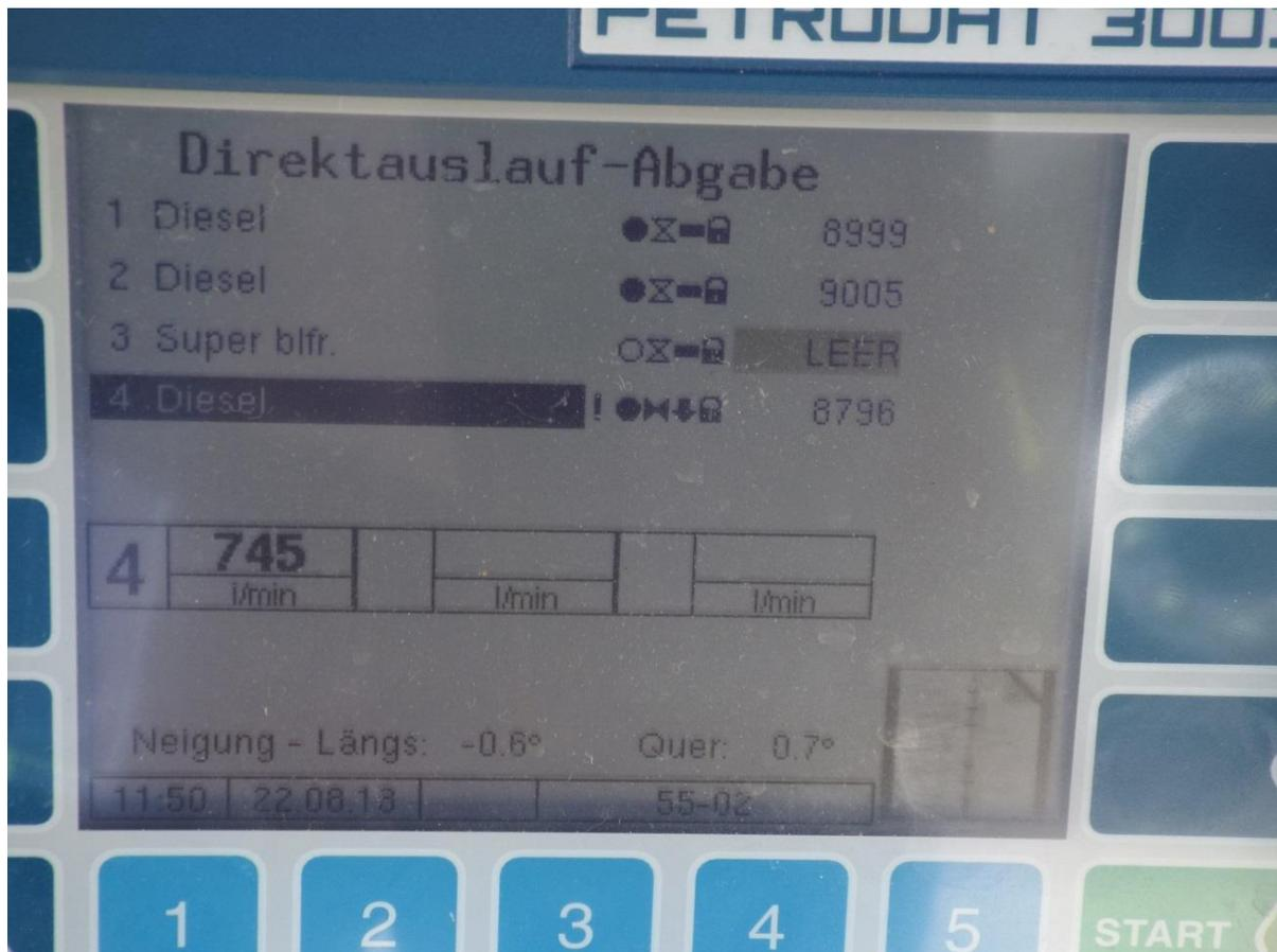
Abbildung 9: Display am Kfz 1 mit Angabe der Pumpleistung (siehe Abb. 3)
