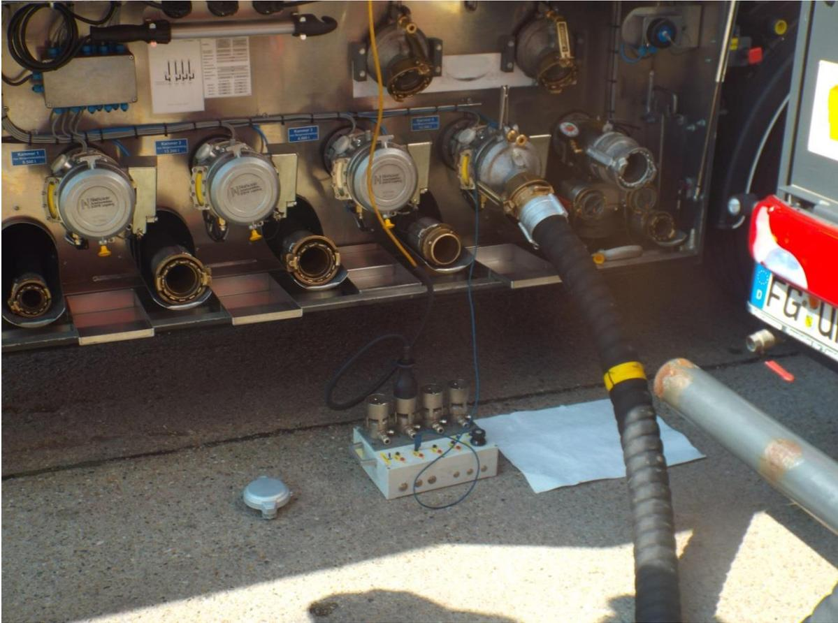
Abbildung 3: Anschluss am Tankstellenfahrzeug (Kfz 1)
