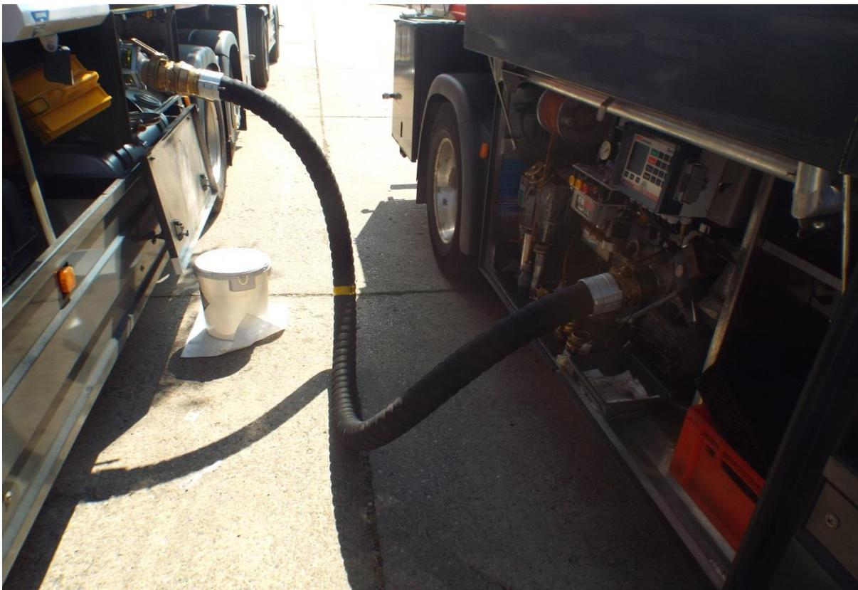
Abbildung 6: Verbindung zwischen dem Saug- und Pumpfahrzeug rechts (Kfz 2) und dem Endkundenfahrzeug links (Kfz 3)
