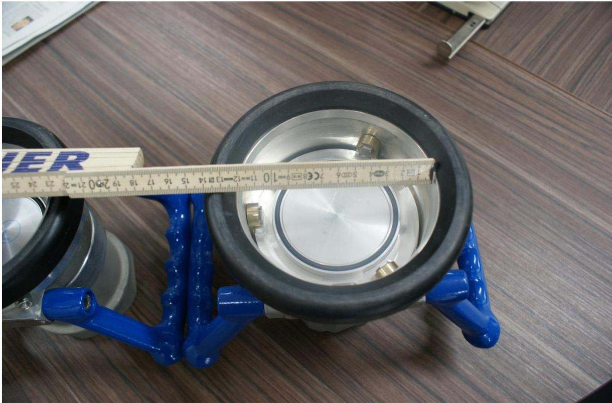
Abbildung 12: Trockenkupplung Dm.119 DDC-M-80-3“
