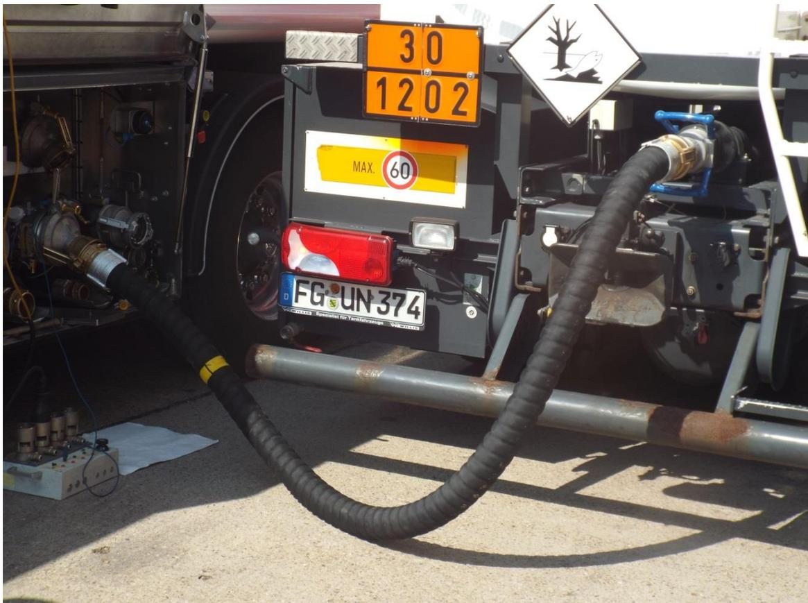
Abbildung 4: Verbindung zwischen dem Tankstellenfahrzeug (Kfz 1) und dem Saug- und Pumpfahrzeug (KfZ 2)
