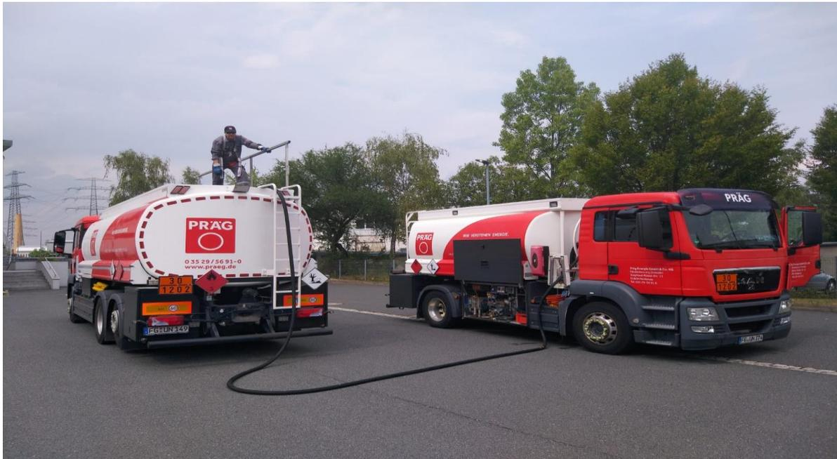
Abbildung 13: Top-Betankung unter Einsatz eines 40m-Vollschlauch
