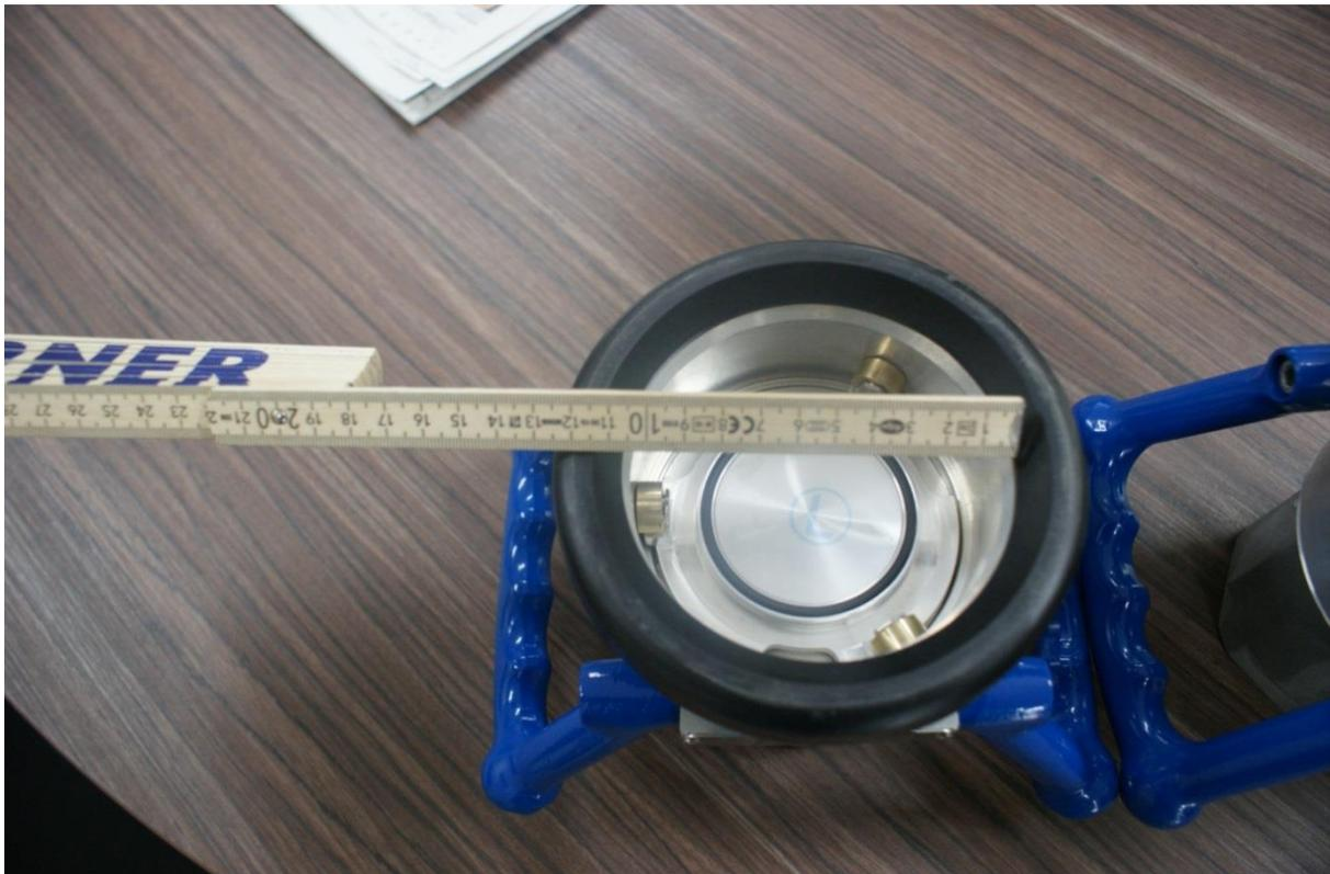
Abbildung 11: Trockenkupplung Dm.105 DDC-M-65-3"
