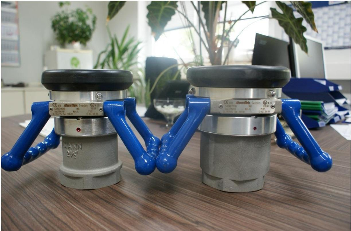
Abbildung 10: Die 2 Trockenkupplungen im Größenvergleich
