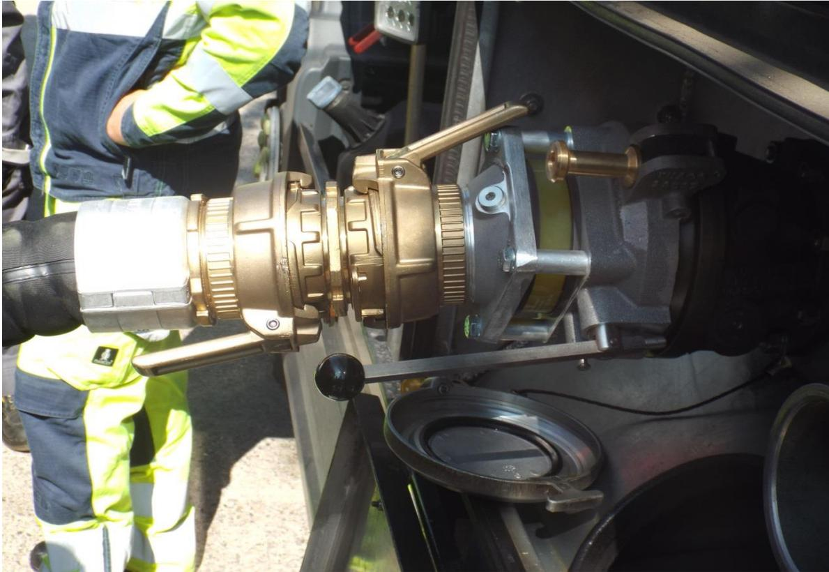
Abbildung 8: Anschluss am Endkundenfahrzeug (Kfz 3) mit Adapter
